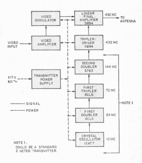
FIG. 14 BLOCK DIAGRAM OF TYPICAL HAM-TV TRANSMITTER
