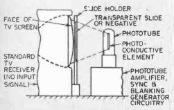
FIG. 5 FLYING-SPOT SCANNER SYSTEM
