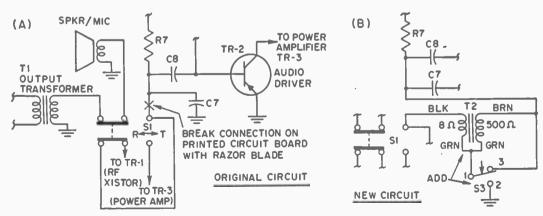
FIGURE 1. C-100 MODULATION MODIFICATION
